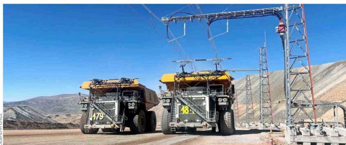
La línea Trolley implementada en Minera Collahuasi está diseñada para soportar la operación simultánea de dos camiones Liebherr T284 de 400 Ton.
