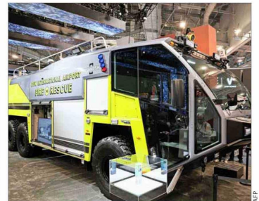
El Oshkosh Striker Volterra es un carro eléctrico de rescate y extinción de incendios ideado para aeropuertos. Es 28% más rápido que uno de diésel.
