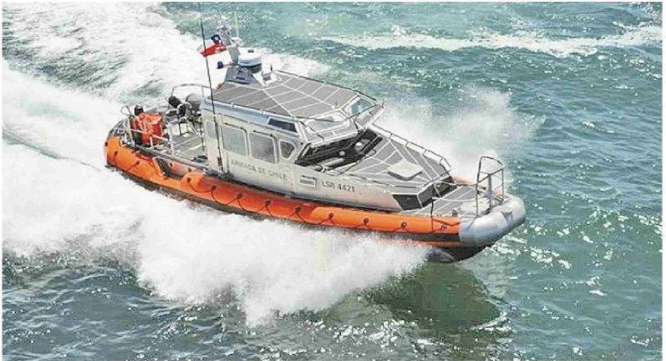
Lancha Arcángel tiene 44 pies de eslora y posee casco de aluminio con collar de espuma lo que le otorga protección y flotabilidad adicional.
