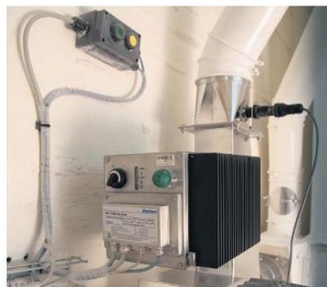
Instrumento NIR DA7300® control harina, proceso
