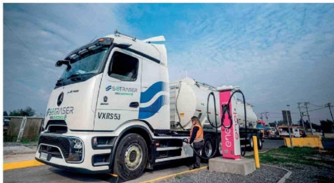
Uno de los primeros cargadores eléctricos destinados a camiones de transporte de alto tonelaje (600 kW de potencia) se encuentra en el área de servicio y descanso Itahue, en Ruta del Maipo ((km. 211), y es parte de un proyecto compuesto por distintas electroestaciones de carga ultrarrápida instaladas en la Ruta 5 Sur.
