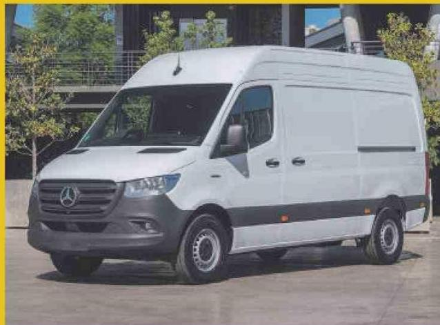
urbano. Ofrece 6,6 m<sup>3</sup> de capacidad, 304 km de autonomía, batería de 60 kWh y motor de 116 cv con 360 Nm. Su recarga toma 6,5 horas en corriente alterna o 35 minutos del 10 al 80% en carga rápida de 80 kW.
