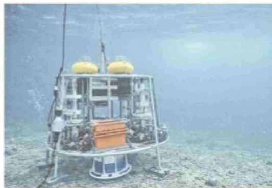
Plataforma submarina multiparamétrica conocida como Lander.
