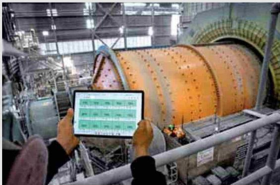
Protorq ha evolucionado desde la simple medición de torque hacia la gestión avanzada de tensión en los pernos. Con el Sistema SPC4, permite monitorear en tiempo real la integridad estructural de los equipos, optimizando la toma de decisiones y maximizando la seguridad operativa.
