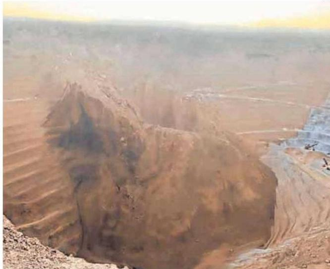
CADA BANCO DE LA MINA TIENE UNA ALTURA APROXIMADA DE 15 METROS. EN LA FOTO EL DERRUMBE DE AYER.
