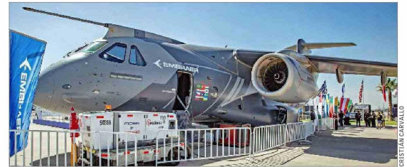
El KC-390 Millennium es el avión más grande fabricado en América Latina. Puede transportar hasta 26 toneladas.
