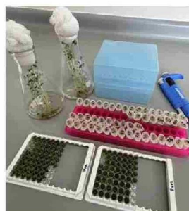
Material vegetal reactivos y placas ELISA preparados para la detección de virus en muestras de plantas.
