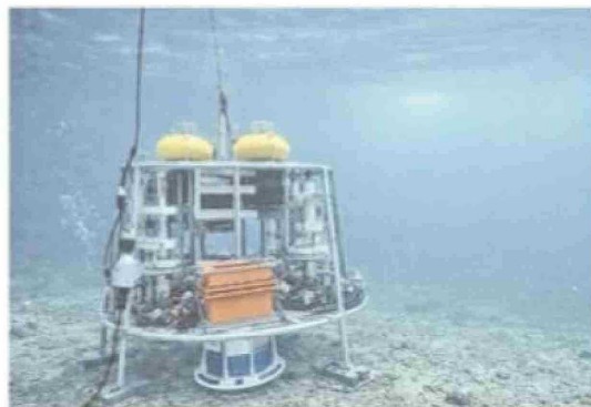
Plataforma submarina multiparamétrica conocida como Lander.
