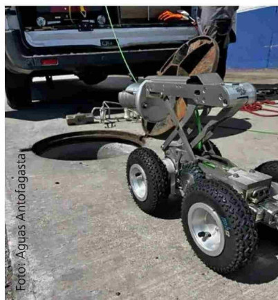
Equipo de teleinspección usado para detectar fugas en las redes de agua potable.
