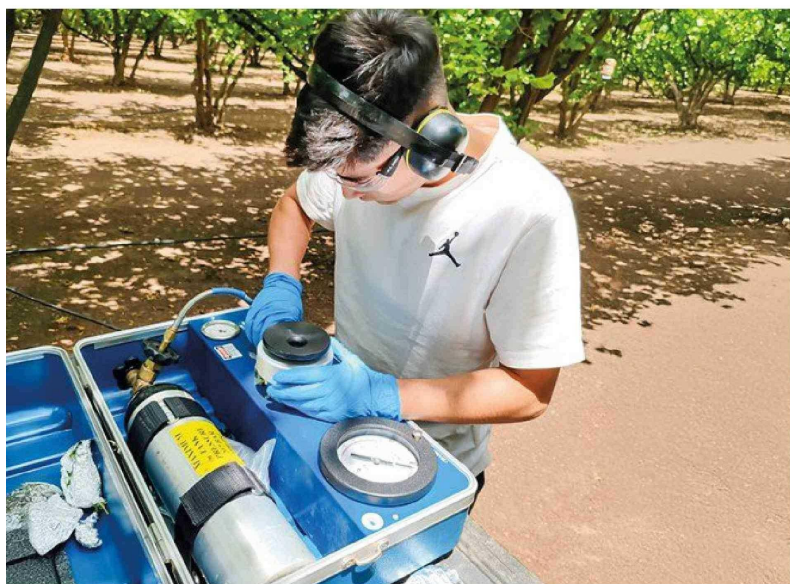
Medición realizada con una cámara Scholander PMS-615, la que permite determinar la disponibilidad de agua libre en tejidos de la planta.
