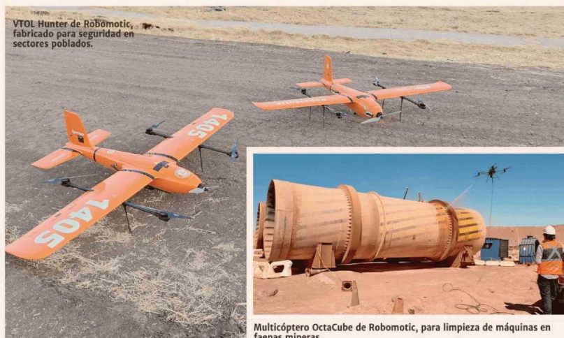
Multicóptero OctaCube de Robomotic, para limpieza de máquinas en faenas mineras.
