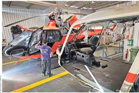
máximo desarme y completa renovación. Además, realizan Mantenimiento Nivel 2 de motores turbina de gas del fabricante francés SAFRAN.
