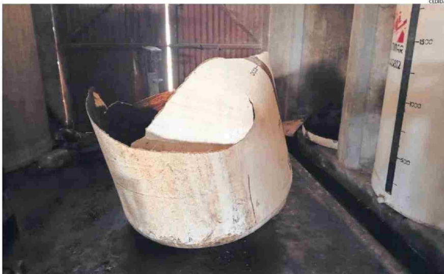
UNA DE LAS CUBAS DE FIBRA DE VIDRIO QUE RESULTARON CON DAÑO.
