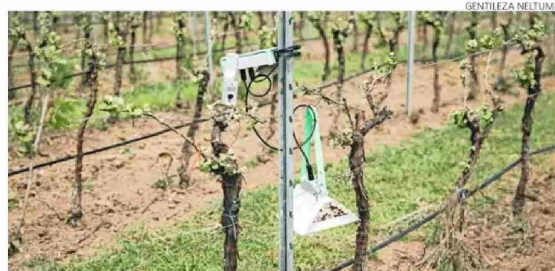
Con dispositivos alimentados con energía solar y que funcionan con IA, Neltume monitorea plagas y cultivos en terreno.
