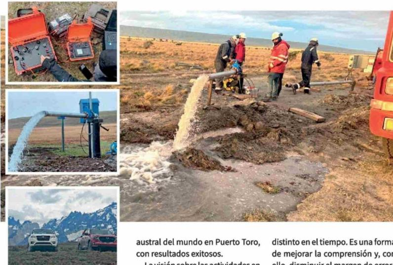
En exploración geofísica, la compañía declara técnicas como tomografía de resistividad eléctrica, sismo-eléctrico, transiente electromagnético y potencial espontáneo, que han permitido obtener los mejores caudales. TAU describe una capacidad relevante para el rubro, una visión en profundidad de hasta 400 metros, con foco en diferenciar zonas con mayor cantidad de agua.
