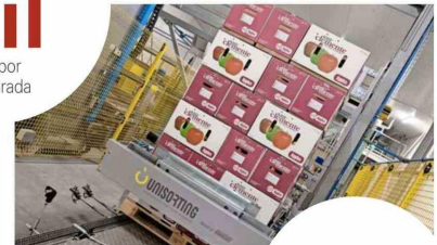
Sistema automático de paletización y flejado Unisorting, capaz de trabajar con distintos tipos de cajas y mosaicos, optimizando almacenamiento y el manejo seguro de la carga.
