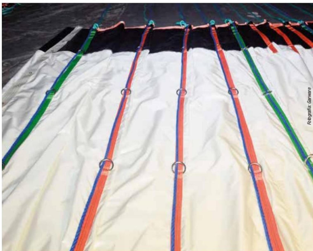
Los faldones anti bloom constituyen una barrera física para bloquear la entrada de microalgas.
