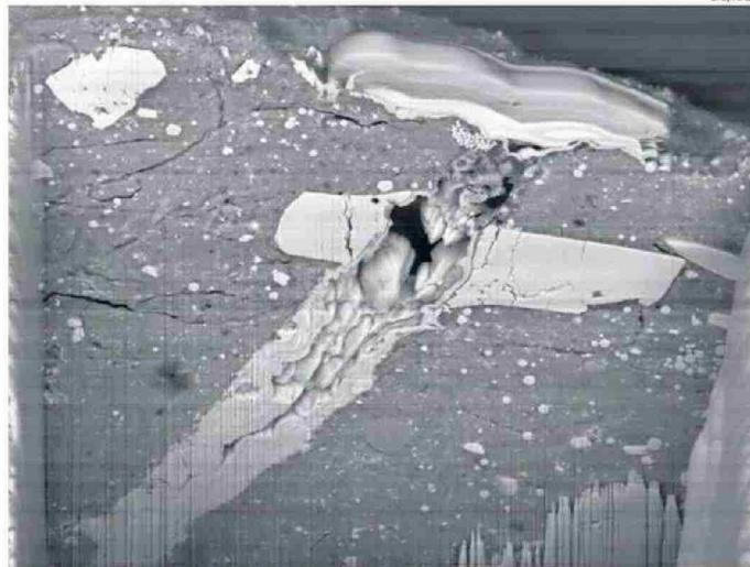
IMAGEN DE MICROSCOPIO ELECTRÓNICO DE BARRIDO DEL CRÁTER DE IMPACTO DE MICROMETEORITO.
