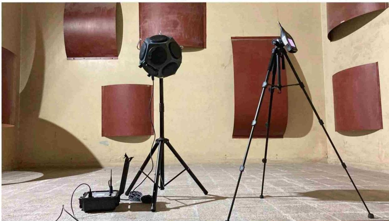
Los ensayos se realizan en cámaras de aislamiento acústico o en cámaras reverberantes.
