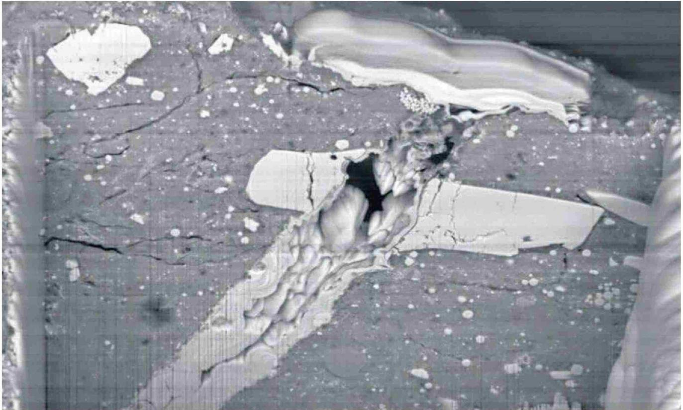
Imagen de microscopio electrónico de barrido del cráter de impacto de micrometeorito en una partícula de material de Bennu.
