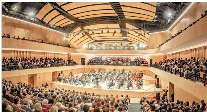
La sala tiene 1.078 butacas que rodean el escenario. También hay “plafones acústicos”, grandes placas de madera suspendidas que permiten configurar la respuesta sonora del auditorio frente a distintos estilos y formatos musicales.
