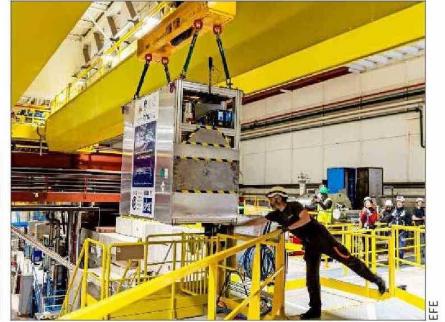
La caja usa imanes superconductores a muy baja temperatura, que permiten a los antiprotones permanecer suspendidos en el vacío, sin tocar las paredes.
