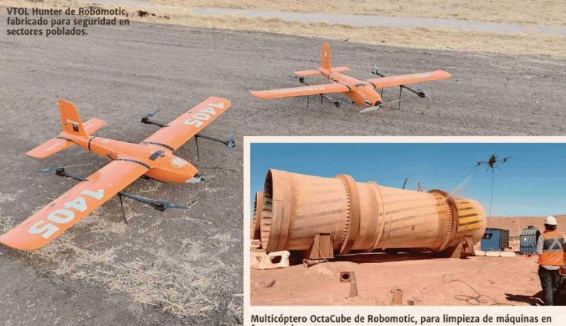
Multicóptero OctaCube de Robomotic, para limpieza de máquinas en faenas mineras.
