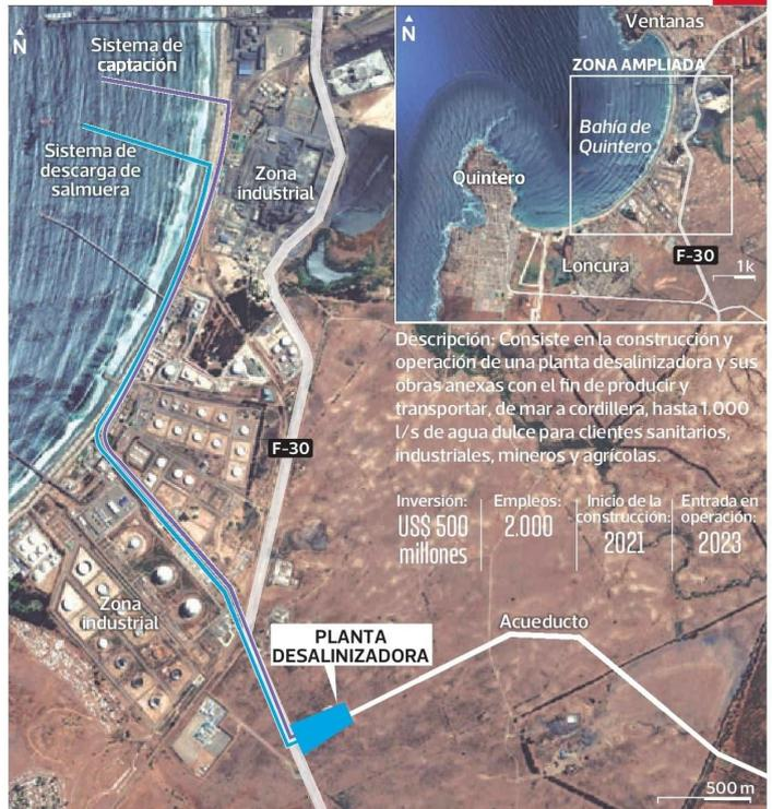
Descripción: Consiste en la construcción y operación de una planta desalinizadora y sus obras anexas con el fin de producir y transportar, de mar a cordillera, hasta 1.000 L/s de agua dulce para clientes sanitarios, industriales, mineros y agrícolas.
