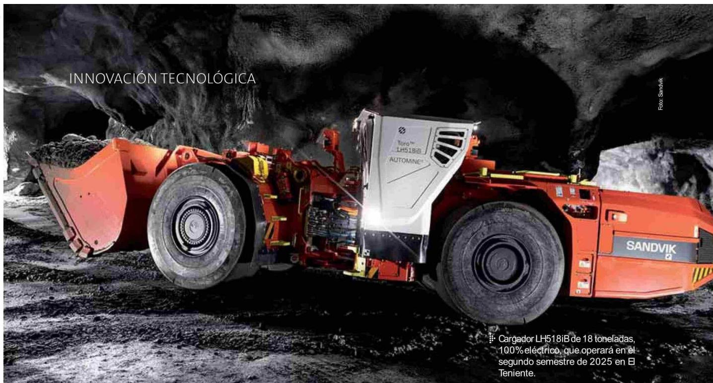
■ Cargador LH518iB de 18 toneladas, 100% eléctrico, que operará en el segundo semestre de 2025 en El Teniente.
