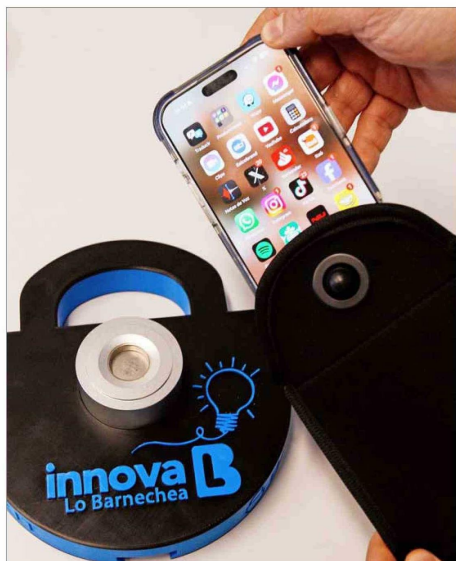
PROYECTO. —Los celulares se guardarán en la funda, que queda cerrada. Para abrirla, se usa el dispositivo de la izquierda.
