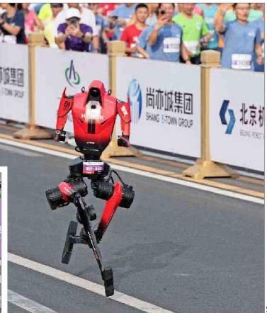
El robot ganador fue diseñado con piernas de unos 95 cm de largo, simulando características de corredores de élite.
