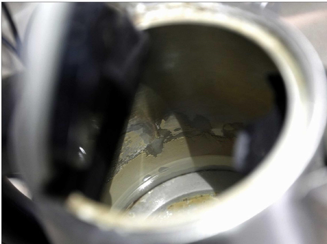
Las incrustaciones de sarro tapan los contactos eléctricos del hervidor.
