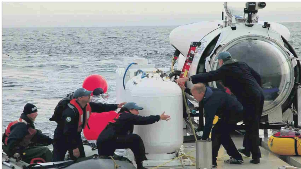
El submarino fue construido en fibra de carbono para que fuera liviano y más barato.
