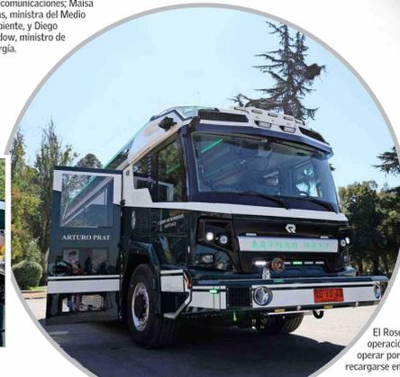
El Rosenbauer RTX es el primer carro bomba eléctrico en operación en Latinoamérica. Su sistema híbrido le permite operar por más de cuatro horas y sus baterías pueden recargarse en solo 45 minutos.
