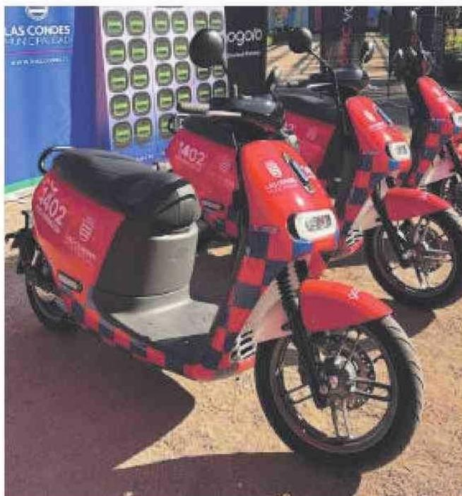
Las unidades tienen una autonomía de 100 kilómetros por carga, velocidad máxima de 105 km/h y están equipadas con frenos regenerativos, iluminación led y conectividad móvil.
