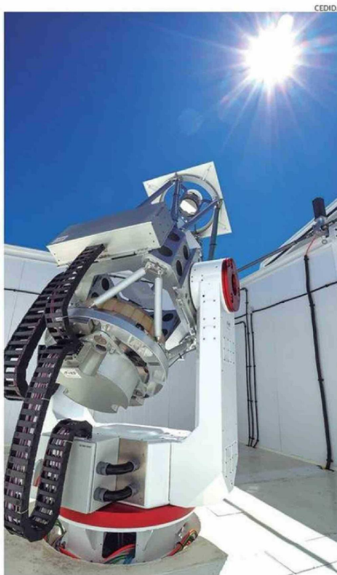
EL TELESCOPIO PRINCIPAL TIENE UN ESPEJO DE 60 CM QUE RECOGE LA LUZ DE PEQUEÑAS REGIONES DEL DISCO SOLAR.
