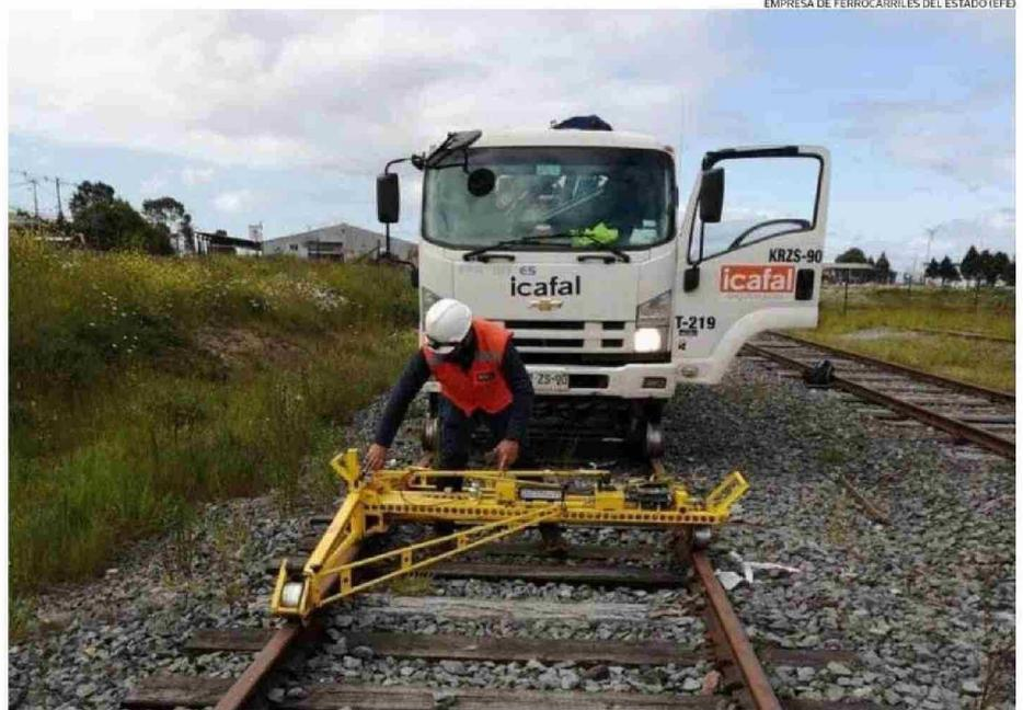
EN LA IMAGEN SE OBSERVA A UN EQUIPO TÉCNICO DE EFE EFECTUANDO UNA REVISIÓN DE GEOMETRÍA DE LA VÍA CON MÁQUINA KRAB.
