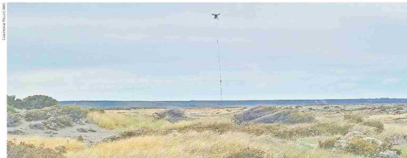
El rastreo con drone equipado de un magnetómetro es parte del proyecto de búsqueda de los cañones que Sarmiento dejó enterrados en Punta Dúngenes en 1584. Proyecto Gore Magallanes 30486520-0/2019, a través de la Ilustre Municipalidad de San Gregorio, en colaboración con la UMag y la Universidad Austral de Chile, coordinación por Alfredo Prieto.
