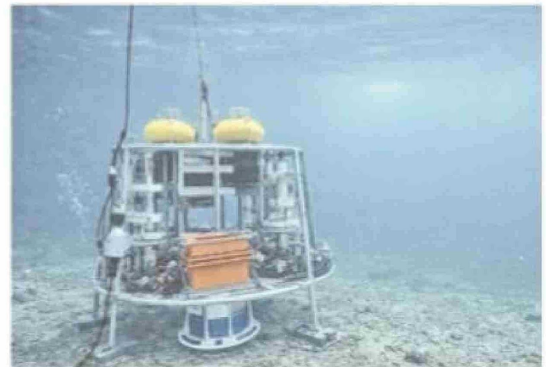
Plataforma submarina multiparamétrica conocida como Lander.
