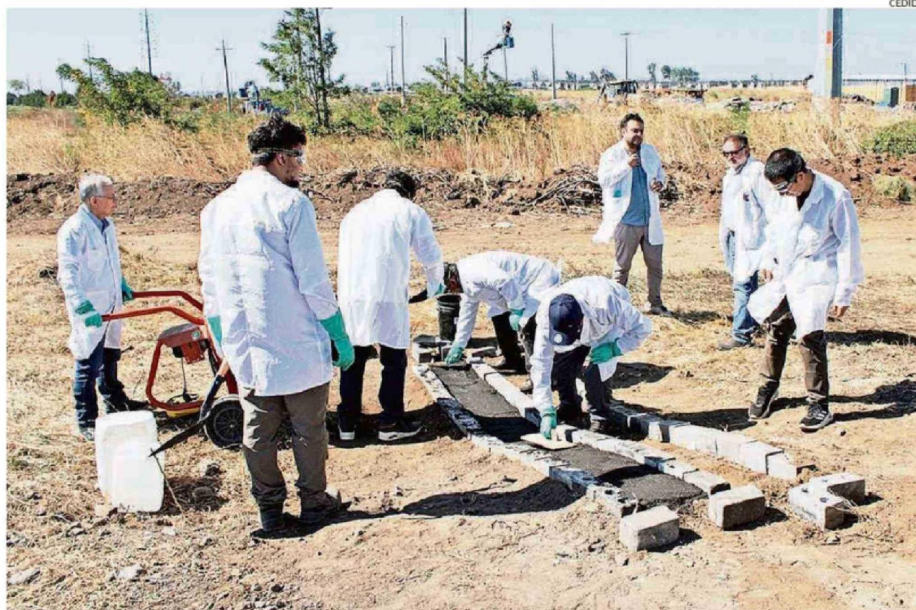
EL PROYECTO VALIDÓ EN TERRENO EL USO DE TES COMO ALTERNATIVA PARA ESTABILIZAR CANALES Y REDUCIR PÉRDIDAS DE AGUA.
