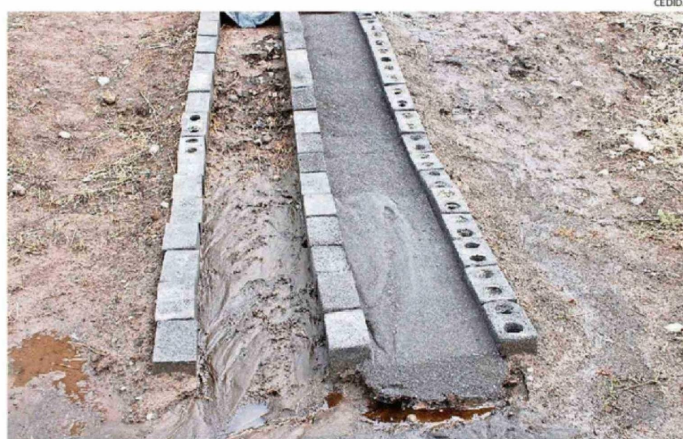
LA INICIATIVA PERMITIÓ EVALUAR EL DESEMPEÑO DEL TES FRENTE A FILTRACIONES, SOCAVACIÓN Y DESBORDES EN INFRAESTRUCTURA DE RIEGO.
