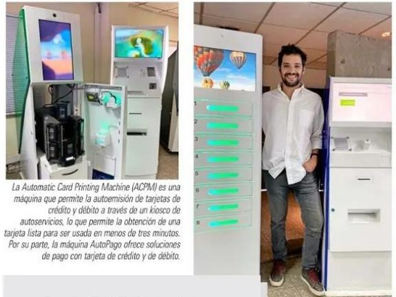
La Automatic Card Printing Machine (ACPM) es una máquina que permite la autoemisión de tarjetas de crédito y débito a través de un kiosco de autoservicio, lo que permite la obtención de una tarjeta lista para ser usada en menos de tres minutos. Por su parte, la máquina AutoPago ofrece soluciones de pago con tarjeta de crédito y de débito.
