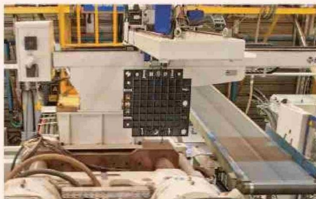
Fabricación local de pisos DEX® con máquinas inyectoras de plástico
