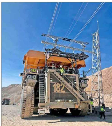
Uno de los camiones electrificados que opera en la minera Collahuasi.
