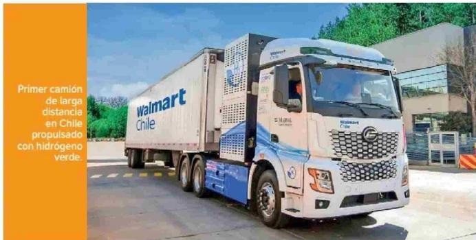
Primer camión de larga distancia en Chile propulsado con hidrógeno verde.
