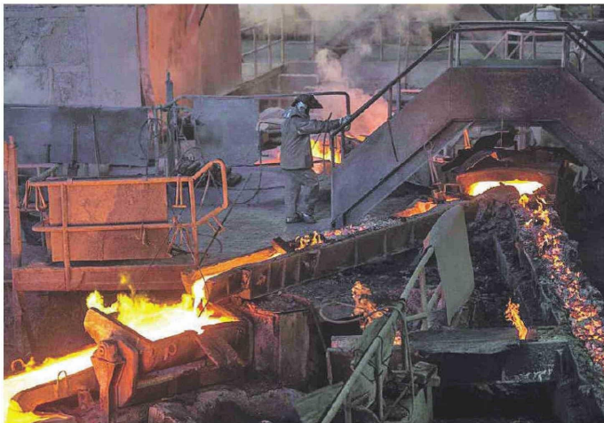
Fundición de Coldeco , donde el cobre blister es transformado en refinado, con 99% de pureza. / XINHUA
