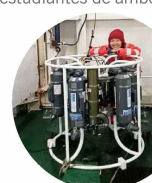
La Dra. Andrea Corredor, de nacionalidad colombiana, prepara la ceta con botellas oceanográficas para colecta de agua a diferentes profundidades.
