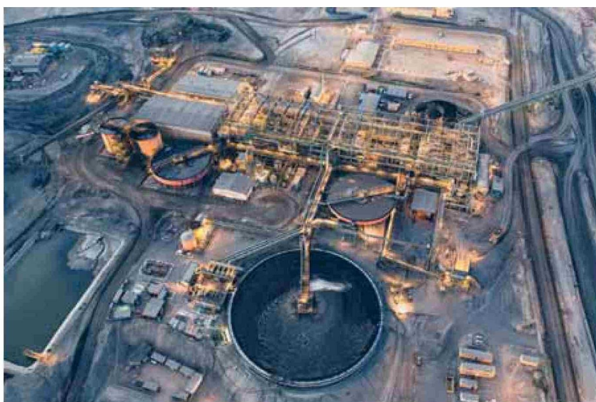
La Planta Magnetita de CMP, permite recuperar minerales de hierro a partir del procesamiento de relaves provenientes de la minería del cobre.
