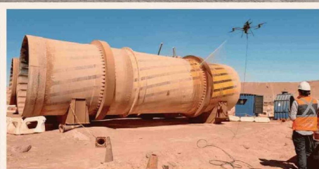
Multicóptero OctaCube de Robomotic, para limpieza de máquinas en faenas mineras.
