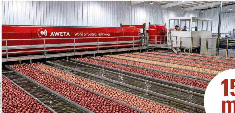
El sistema Presizer permite preclasificar la fruta a partir del ingreso, ordenando el flujo productivo desde su origen.
