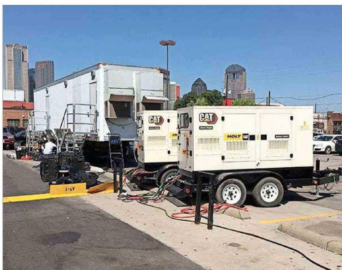
Motores Caterpillar, con tecnología Stage V de la UE y Tier 4 final de la EPA EEUU.
